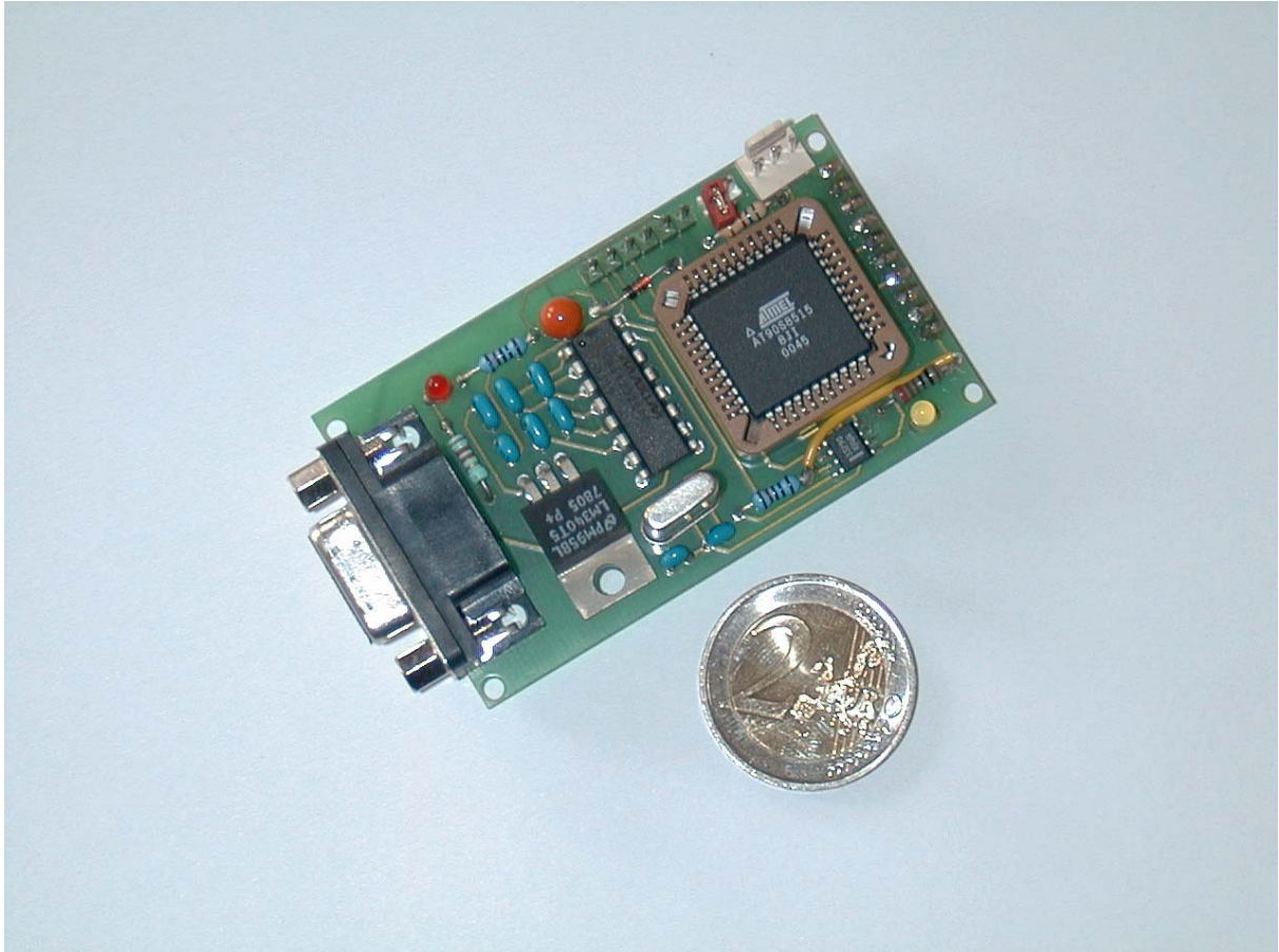
Abbildung 2.2: Kommunikations- und Signalverarbeitungseinheit eines Smart Sensors (basierend auf einem AT90S8515 Mikrocontroller)
